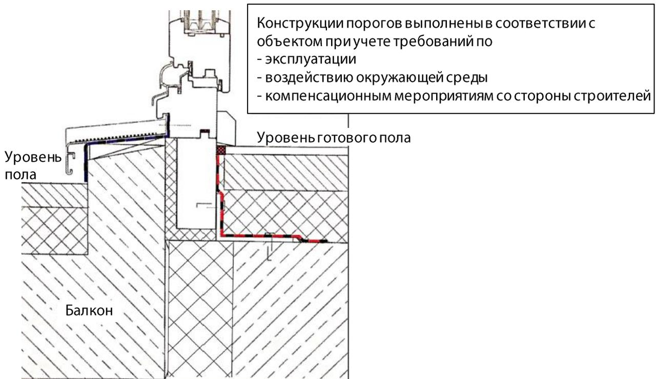
**Рис. 7.30** Пример конструкции порожка оконной (балконной) двери при монтажной ситуации без выполненного строительной организацией уплотнения по DIN 18195
