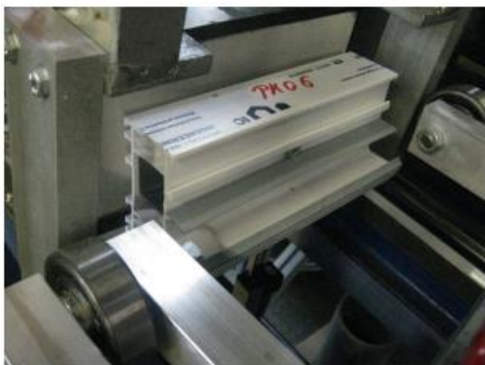
Изображение 5 Вариант 1: крепление через главную камеру и армирующий профиль
