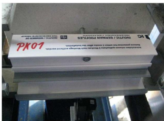
Вид 2 Схема испытания (воздействие ветровой нагрузки)
