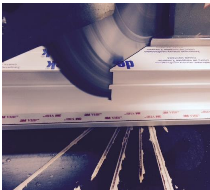
Фото 1. Положение профиля на столе станка
